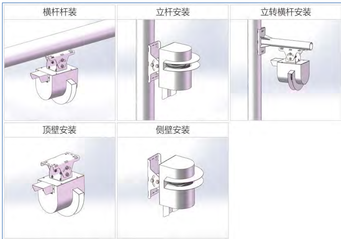
图 3-3 使用防护外壳固定方式
